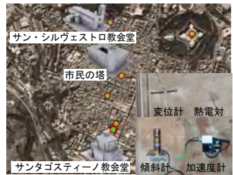
図2 ラクイラのモニタリング対象建物とセンサー
