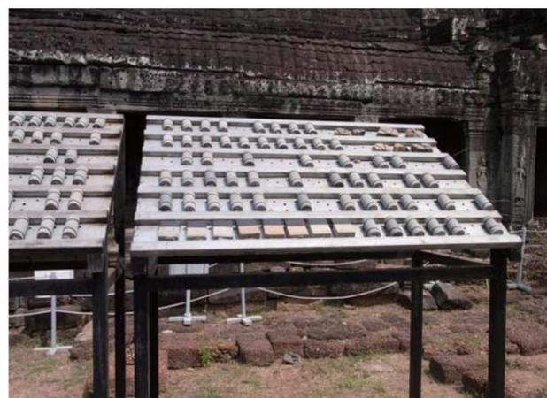
保存材料の耐候試験を行っている曝露台
